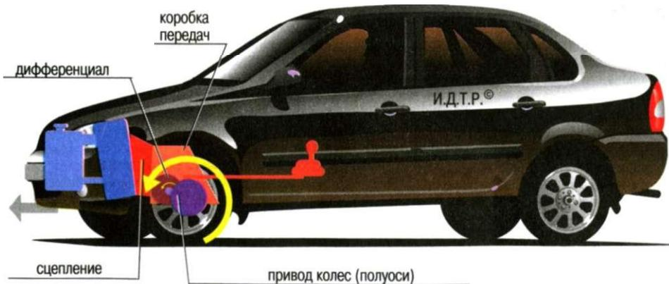
двигателя подхватывает сцепление и передает его коробке передач, затем в работу включается главная передача с дифференциалом, которые и распределяют крутящий момент между двух полуосей, снабженных шарнирами равных угловых скоростей (ШРУСами). Эти шарниры, как сообщалось ранее, позволяют передавать крутящий момент на передние ведущие колеса независимо от того, повернуты они или нет. Вот так добирается крутящий момент до колес на переднеприводном автомобиле.
