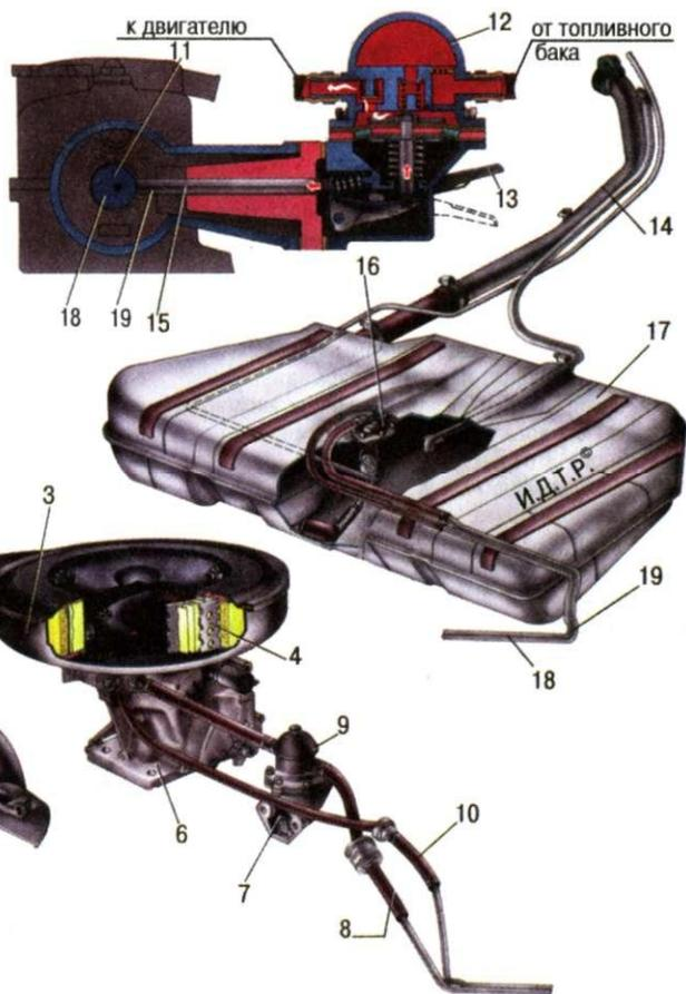
Бензин, залитый в бак легкового автомобиля, предварительно очищается **сетчатым фильтром**, установленным внутри бака на топливозаборнике. Еще в бензобаке размещен датчик уровня топлива (поплавок с реостатом), показания которого выводятся на щиток приборов. У большинства легковых автомобилей при уменьшении уровня бензина до 5-8 л на щитке приборов загорается лампочка, сигнализирующая о необходимости дозаправки.
